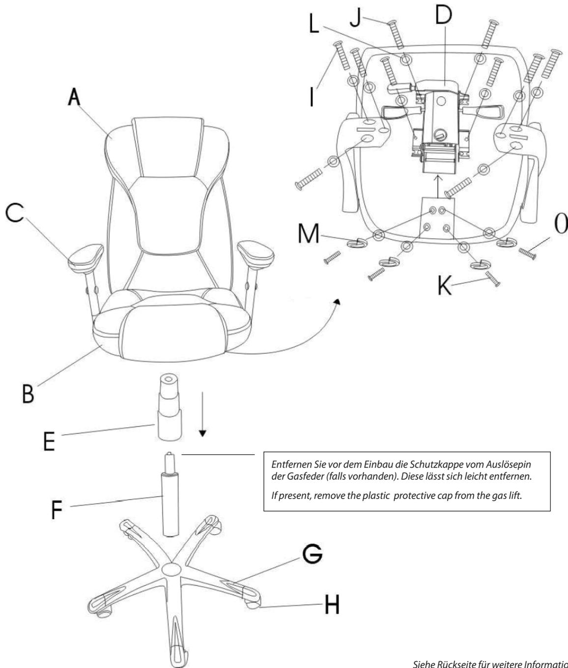
Entfernen Sie vor dem Einbau die Schutzkappe vom Auslösepin der Gasfeder (falls vorhanden). Diese lässt sich leicht entfernen.
