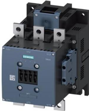
Leistungsschütz, AC-3e/AC-3 300 A, 160 kW / 400 V AC (50-60 Hz) / DC U<sub>c</sub>: 42-48 V 3-polig, Hilfskontakte 2 S + 2 Ö Antrieb: konventionell Hauptstr.: Schiene Steuer- und Hilfsstromkreis: Schraubanschluss
