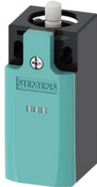
Positionsschalter Metallgehäuse nach DIN EN 50047, 31 mm Geräteanschluss 1 x (M20 x 1,5) 1S/2Ö Schleichkontakte mit 2 LEDs gelb/grün, DC 24 V
