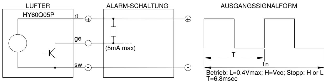
**WICHTIG:** Der Tachoaussgang ist *nicht* gegen Kurzschluss gesichert und darf ohne Vorwiderstand nicht an GND oder VCC angeschlossen werden. Ein Pull-up-Widerstand wird nicht benötigt. Nicht benutzten Tachoaussgang offen lassen (isolieren).
