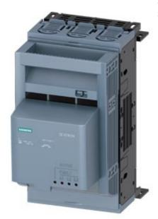
SENTRON, Sicherungslasttrennschalter 3NP1, 3-polig, NH00, 160 A, für Sammelschienensystem 8US 60mm, Flachanschluss, Sicherungsüberwachung, elektronisch EFM15, Abdeckebene 32/70mm
