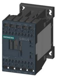
CONTACTOR, AC-3, 4KW/400V, 1NO, AC110V 50HZ, 120V 60HZ 3-POLE, SZ S00 SPRING-LOADED TERMINAL
