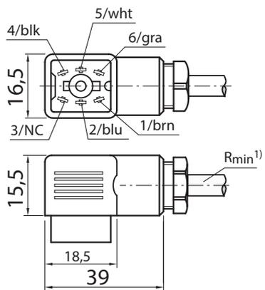
① Minimaler Biegeradius bei dynamischem Einsatz  $R_{min} = 20 \times$  Leitungsdurchmesser
