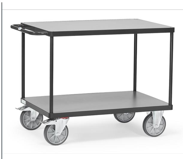
Ensemble mécano-soudé, revêtement époxy gris anthracite RAL 7016 avec 2 plateaux en mélaminé surface gris moyen. Charge maximum plateau du haut : 200 kg. 2 roues pivotantes et 2 roues fixes à bandage TPE, moyeu à roulement à billes central. Freins sur roues pivotantes, conformément à la Norme 1757-3 (Sécurité des chariots de manutention).
