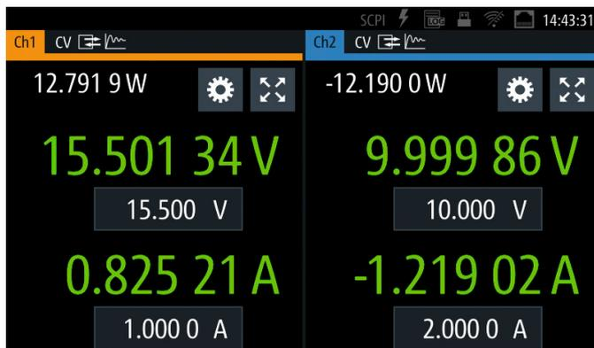
In den R&S®NGM200 Netzgeräten kommt eine Schaltung zum Einsatz, bei der Anwender das Regelverhalten in zwei Stufen einstellen können. Die standardmäßig eingestellte Stufe „Fast“ ist auf Geschwindigkeit optimiert, hier werden Ausregelzeiten von  $< 30 \mu\text{s}$  erzielt. Das Deaktivieren der Stufe „Fast“ bewirkt eine Einstellung mit etwas längerer Ausregelzeit, bei der das Augenmerk auf der Vermeidung von Überschwingern bei speziellen Lastbedingungen liegt.
