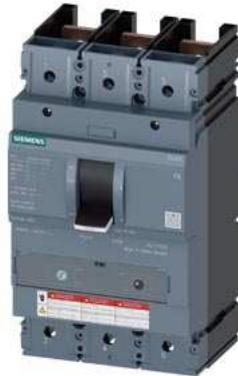
Leistungsschalter 3VA5 UL Frame 400 Schaltvermögenklasse H 65kA @ 480 V 3-polig, Anlagenschutz TM230, FTAM, In=225A Überlastschutz, 100%-rated Ir=225A fest eingestellt Kurzschlusschutz li=5...10 x In ohne Anschluss
