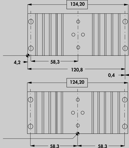
Bei Berücksichtigung der ungünstigsten Preßtoleranzen ergibt sich zwischen beiden Bemaßungsarten, bezogen auf die Symmetrieachse, eine Differenz von 0,4 mm.
