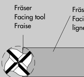
Fräser größer als zu fräsende Fläche, keine Fräskante
