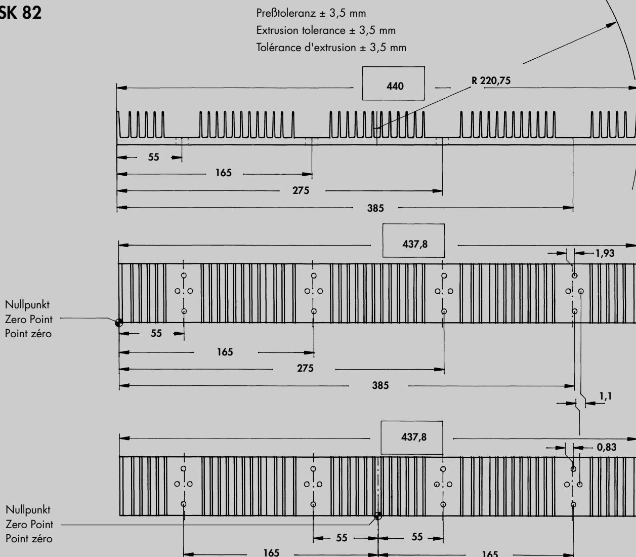
Bei Berücksichtigung der ungünstigsten Preßtoleranzen ergibt sich zwischen beiden Bemaßungsarten, bezogen auf die Symmetriechse, eine Differenz von 1,1 mm.
