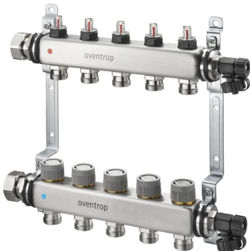
Der Multidis SFQ ist ein Heizkreisverteiler, der für eine optimale Wärmeverteilung der einzelnen Heizkreise sorgt. In Verbindung mit einem Raumthermostaten und einem Stellantrieb erfolgt eine effiziente Regulierung der benötigten Durchflussmenge. Der Heizkreisverteiler hat integrierte Q-Tech Ventileinsätze, die einen automatischen hydraulischen Abgleich ermöglichen. So wird eine optimale Wärmeverteilung erreicht und dadurch die Heizkosten reduziert.
