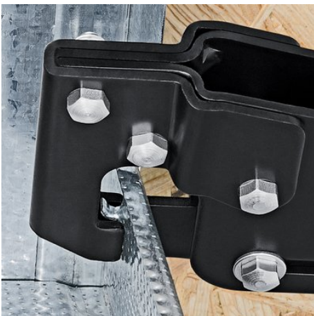
Het ponsgereedschap wordt door de plaat gedrukt
