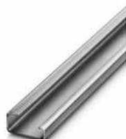
Tragschiene ungelocht, nach EN 60715, Material: Stahl, verzinkt, dickschichtpassiviert, G-Profil, Farbe: silberfarben, Verpackungsvariante mit 10 Stück (20 m)
