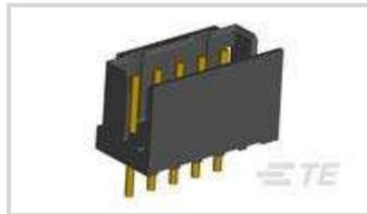
PCB-Steckverbindermontagetyp: **Stiftleiste für die Leiterplattenmontage**Montageausrichtung für Leiterplatte: **Vertikal**Steckverbindersystem: **Draht-an-Leiterplatte**Anzahl von Positionen: **6**Raster: **2 mm [.079 in]****Eigenschaften****Produktmerkmale**
