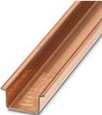
Tragschiene ungelocht, ähnlich EN 60715, Material: Kupfer, unbeschichtet, Standardprofil, Farbe: kupferfarben, Verpackungsvariante mit 10 Stück (20 m)
