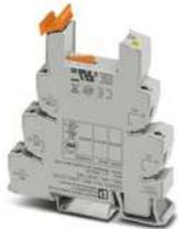
14 mm PLC-Grundklemme für hohe Dauerströme mit Schraubanschluss, ohne Relais- oder Solid-State-Relaisbestückung, zur Montage auf Tragschiene NS 35/7,5, 1 Wechsler, Eingangsspannung 24 V AC/DC
