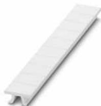
Zackband, Streifen, weiß, unbeschriftet, beschriftbar mit: CMS-P1-PLOTTER, PLOTMARK, Montageart: verrasten, für Klemmenbreite: 8,2 mm, Schriftfeldgröße: 10,5 x 8,15 mm, Anzahl der Einzelschilder: 10
