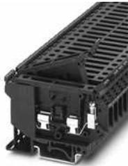
Sicherungsreihenklemme, Art der Sicherung: Glas / Keramik / ..., Sicherungstyp: G / 5 x 20 / 5 x 25 / 5 x 30, Nennspannung: 800 V, Nennstrom: 6,3 A, Anschlussart: Schraubanschluss, Bemessungsquerschnitt: 1 mm<sup>2</sup>, Querschnitt: 0,2 mm<sup>2</sup>- 4 mm<sup>2</sup>, Montageart: NS 35/7,5, NS 35/15, NS 32, Farbe: gelb
