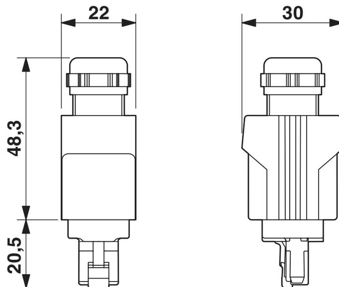
Push-Pull RJ45-Steckverbinder IP65/67
