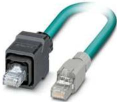
Konfektioniertes Ethernet-Kabel, geschirmt, 4-paarig, AWG 26 schleppkettentauglich (19-drähtig), RAL 5021 (wasserblau), RJ45-Stecker/IP67 Push-Pull Kunststoffgehäuse auf RJ45-Stecker/IP20, Line, Länge 2 m
