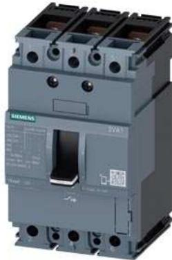
Leistungsschalter 3VA1 IEC Frame 100 Schaltvermögenklasse B Icu=16kA @ 415V 3-polig, Anlagenschutz TM210, FTFM, In=100A Überlastschutz Ir=100A fest eingestellt Kurzschlusschutz Ii=10 x In Schraubenflachanschluss
