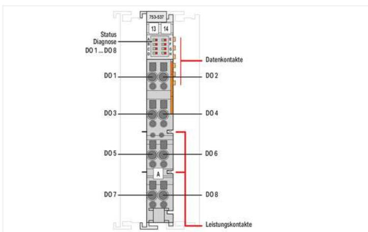
Über das Digitalausgangsmodule werden Steuersignale aus dem Automatisierungsgerät an die angeschlossenen Aktoren weitergegeben. Alle Ausgänge sind kurzschlussfest ausgeführt. Das Modul erkennt Überlast, Kurzschluss und Leitungsbruch. Der Status wird an den Feldbuskoppler übertragen und über LEDs angezeigt. Das Modul besitzt acht Ausgangskanäle und ermöglicht den Anschluss von acht Aktoren. Feld- und Systemebene sind galvanisch getrennt.
