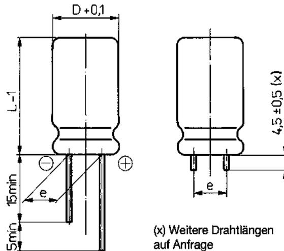
Die Polaritätskennzeichnung erfolgt durch das Stempelbild.
