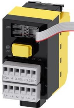
SIRIUS ACT mit PROFINET: fehlersicheres Interfacemodul mit 4 DI, 1 DQ (DC 24 V), 1 AI (12-Bit A/D Auflösung), 24V DC, Schraubanschluss, Frontplattenbefestigung, 1 bis 20 Terminalmodule anschließbar
