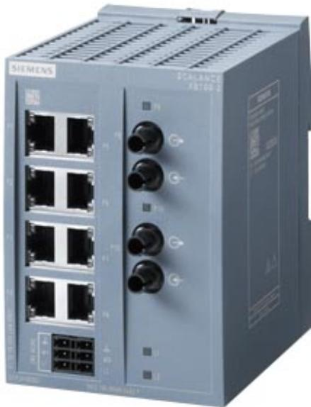
SCALANCE XB108-2 unmanaged IE Switch, 8x 10/100 Mbit/s Ports, 2x 100 Mbit/s Multimode BFOC, zum Aufbau von kleinen Stern- und Linienstrukturen, LED-Diagnose, IP20, redundante Spannungsversorgung AC/DC 24V Handbuch als Download verfügbar
