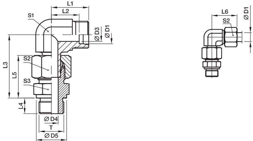
Pré-assemblé, avec union mâle orientable (à étanchéité métallique).
