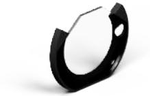
Sperrfilter IR blockieren infrarotes Licht, ohne dabei das Bild zu verfärben. Empfohlen wird die Verwendung bei Weißlicht- sowie Farbanwendungen, bei denen störendes IR-Licht auftreten kann. Der Filter wird werkzeuglos im Beleuchtungsmodul fixiert und bleibt bei Verwendung des Schutztubus auch bei Vibrationen oder versehentlichen Bewegungen während der Reinigung optimal positioniert.
