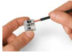
Leiter anschließen: Klemmstelle durch Betätigungshebel öffnen und Leiter einführen.
