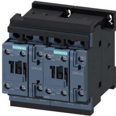
Wendekombination AC-3, 7,5 kW/400 V, AC24V, 50/60Hz 3-polig, Baugröße S0 Schraubanschluss elektrische und mechanische Verriegelung 2 S integriert
