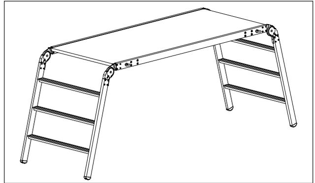
6. Arbeitsplattform gegen Umkippen sichern. Dazu die Sicherungsösen an der Arbeitsplattform verwenden.
