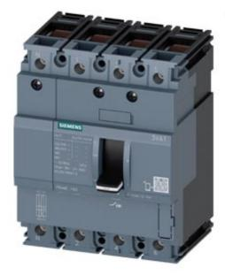
Leistungsschalter 3VA1 IEC Frame 160 Schaltvermögenklasse H Icu=70kA @ 415V 4-polig, Anlagenschutz TM210, FTFM, In=100A Überlastschutz Ir=100A fest eingestellt Kurzschlussschutz Ii=10 x In N-Leiter ungeschützt Klemmenanschluss
