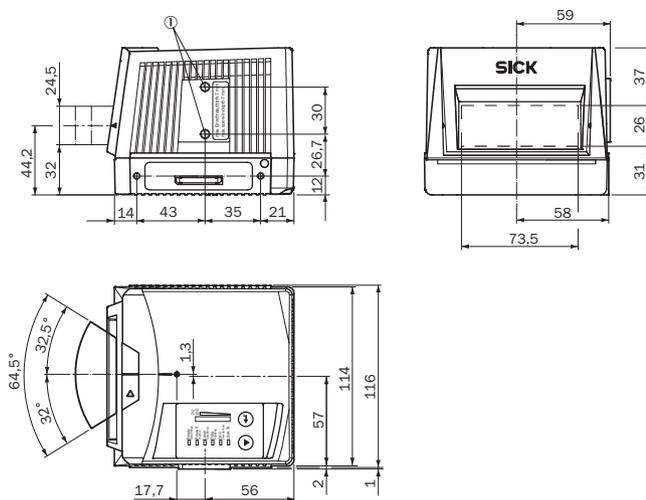
① Sacklochgewinde M6, 7 mm tief (2 x), zur Befestigung
