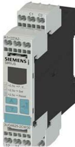
DIGITALES UEBERWACHUNGSRELAIS ZUR FEHLERSTROMUEBERWACHUNG (MIT STROMWANDLER 3UL23) EINSTELLBEREICH 0,03 A BIS 40 A GETRENNT FUER WARNSCHWELLE UND ABSCHALTWERT VERSORGUNGSSPANNUNG AC/DC 24 .. 240 V, 50 .. 60 HZ ANLAUF UND AUSLOESEVERZOEGERUNG 0,1 BIS 20S ABSCHALT-HYSTERESE BIS 50% WARN-HYSTERESE 5% FEST BREITE 22,5 MM, 2 WECHSLER MIT ODER OHNE FEHLERSPEICHER FEDERZUGTECHNIK
