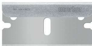
Die BÜGELKLINGE NR. 144 von MARTOR ist eine hochwertige Klinge aus rostfreiem Stahl. Sie ist sehr scharf und verfügt über eine nutzbare Schneide. Die Klinge ist 39,5 mm lang, 19,3 mm breit und 0,25 mm stark. Das für die Klinge verwendete Öl ist lebensmittelecht.
