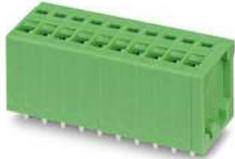
Leiterplattenklemme, Nennstrom: 12 A, Bemessungsspannung (III/2): 200 V, Nennquerschnitt: 1 mm<sup>2</sup>, Anzahl der Potenziale: 18, Anzahl der Reihen: 1, Polzahl pro Reihe: 18, Artikelfamilie: ZFKDS(A) 1-V, Rastermaß: 3,81 mm, Anschlussart: Zugfederanschluss, Montage: Wellenlöten, Anschlussrichtung Leiter/Platine: 90 °, Farbe: grün, Pin-Layout: Lineares Pinning, Pinlänge [P]: 3,5 mm, Anzahl der Lötpins pro Potenzial: 2, Verpackungsart: verpackt im Karton
