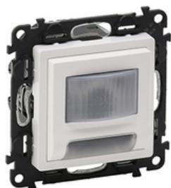
Valena Life Stufenbeleuchtung mit Bewegungsmelder Zum Beleuchten von Hindernissen und Bodenunebenheiten. Mit integriertem Bewegungsmelder und abschaltbarem akustischen Signal. – Erfassungsbereich: 180° – Detektionsreichweite: 6 m max. – Helligkeitsschwellwert: 2,5 lux fix – Ausschaltverzögerung: 30 Sek. fix – Montagehöhe: 30 cm bis 1,2 Meter – Frontale Ausleuchtung: 1 – 2 m (je nach Montagehöhe) – Leuchtmittel LED: 1,3 W – Schraubklemmenanschluss: L und N. Farbe: Ultraweiß
