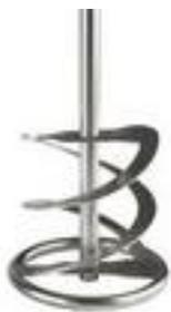
Zwei rechts geformte Wendeln zum Kneten und Mischen von zähen bis pastösen Materialien. Der Rührstab schraubt sich selbst nach unten und drückt das Mischgut nach oben. Sehr vielseitig einsetzbar für: Fliesenkleber, Fugenmasse, Spachtelmasse, Fertigputz, Klebemörtel, Ausgleichsmasse, Estrich.
