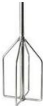
Rührarme aus Rundmaterial verhindern das Einrühren von Luftblasen. Ideal für alle Materialien, bei denen Lufteinschlüsse zu vermeiden sind: Ausgleichsmassen, Spachtelmassen, Kleber, Dichtstoffe.
