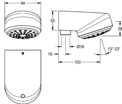
AQUAJET-Comfort - Duschkopf DN 15 mit stufenlos winkelverstellbarem Kunststoffstrahlboden 13° - 23°, Antikalk-System und geringer Ae rosolbildung. Ausführung für Aufputzrohrmontage 18 mm und beiliegenden Durchflussmengenreglern 6,0 l/min, 9,0 l/min und 12,0 l/min. Gehäuse Messing poliert verchromt.
