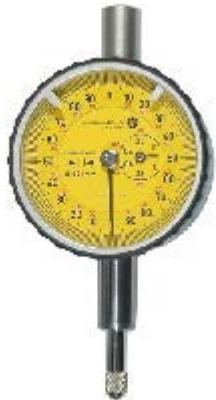
Klein-Messuhren; Nr. 33009, 33010 und 33018 nicht in DIN 878 enthalten; Die Klein-Messuhren mit 23,5 mm langem Schaft werden als Spezialausführung für die SUBITO und DIATEST Innen-Feinmessgeräte verwendet; Besonderheit stoßgeschützt; Außen-Durchmesser 40 mm; Skalenteilungswert 0,001 mm; Messspanne 1 mm; Anzahl der Zeiger 2; Eine Umdrehung des großen Zeigers 0,2 mm; Ausführung Außenring Kunststoff; Schaftausführung normal
