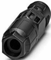
Leitungsverbinder, QUICKON-Anschluss, Polzahl: 3+PE, 0,5 mm<sup>2</sup> ... 1,5 mm<sup>2</sup>, 690 V, 17,5 A, schwarz, mit einer QUICKON-Mutter, Leitungsaußendurchmesser: 5 mm ... 9,5 mm, QUICKON-Schnellanschluss
