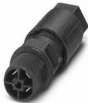
Wanddurchführung, QUICKON-Anschluss, Polzahl: 3+PE, 0,5 mm<sup>2</sup> ... 1,5 mm<sup>2</sup>, 690 V, 15 A, schwarz, mit QUICKON-Mutter, Leitungsaußendurchmesser: 5 mm ... 9,5 mm, Montagegewinde: M20, Flachsteckanschluss (für Flachsteckhülsen nach DIN 46247-2), 1,5 mm<sup>2</sup>
