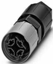
Steckverbinder, QUICKON-Anschluss, Polzahl: 3+PE, 0,5 mm<sup>2</sup> ... 1,5 mm<sup>2</sup>, 690 V, 17,5 A, schwarz, mit QUICKON-Mutter, Leitungsaußendurchmesser: 5 mm ... 9,5 mm
