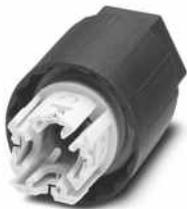
Mutter, QUICKON-Anschluss, Polzahl: 3+PE, 0,5 mm<sup>2</sup> ... 1,5 mm<sup>2</sup>, 690 V, 17,5 A, schwarz, Leitungsaußendurchmesser: 5 mm ... 9,5 mm
