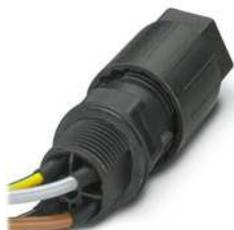
Wanddurchführung, QUICKON-Anschluss, Polzahl: 3+PE, 0,5 mm<sup>2</sup> ... 1,5 mm<sup>2</sup>, 690 V, 17,5 A, schwarz, mit QUICKON-Mutter, Leitungsaußendurchmesser: 5 mm ... 9,5 mm, Montagegewinde: M20, Einzeladern, 1,5 mm<sup>2</sup>, Leitungslänge: 1 m
