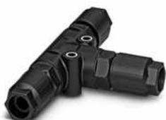
T-Verteiler, QUICKON-Anschluss, Polzahl: 3+PE, 0,5 mm<sup>2</sup> ... 1,5 mm<sup>2</sup>, 690 V, 17,5 A, schwarz, mit drei QUICKON-Muttern, Leitungsaußendurchmesser: 5 mm ... 9,5 mm
