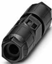
Leitungsverbinder, QUICKON-Anschluss, Polzahl: 3+PE, 0,5 mm<sup>2</sup> ... 1,5 mm<sup>2</sup>, 690 V, 17,5 A, schwarz, mit zwei QUICKON-Muttern, Leitungsaußendurchmesser: 5 mm ... 9,5 mm, QUICKON-Schnellanschluss
