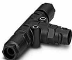
T-Verteiler, QUICKON-Anschluss, Polzahl: 3+PE, 0,5 mm<sup>2</sup> ... 1,5 mm<sup>2</sup>, 690 V, 17,5 A, schwarz, mit zwei QUICKON-Muttern, Leitungsaußendurchmesser: 5 mm ... 9,5 mm
