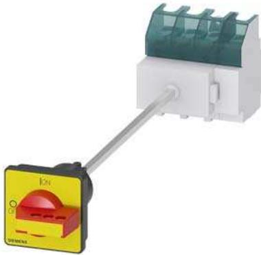
SETRON, Lasttrennschalter 3LD, Not-Aus-Schalter, 4-polig, Iu: 63 A, Betriebsleistung / bei AC-23 A bei 400V: 22 kW, Bodenbefestigung mit Türkupplung, überlistbarer Knebelantrieb, rot/gelb, 4-Loch Befestigung der Handhabe
