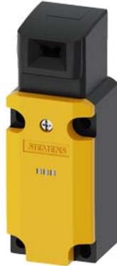
Sicherheits-Positionsschalter mit getrenntem Betätiger Kunststoffgehäuse 40 mm 1 x (M20 x 1,5) Schleichschaltglieder 1S+2Ö mit 2 LEDs gelb/grün DC 24 V 5 Anfahrrichtungen der dazu passende getrennte Betätiger 3SE5000-0AV0. muss separat bestellt werden
