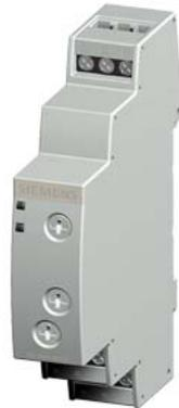
Zeitrelais, elektronisch Multifunktion 2 Wechsler, 7 Funktionen 7 Zeitbereiche 0,05 s ... 100 h AC/DC 12-240 V mit LED, Schraubanschluss
