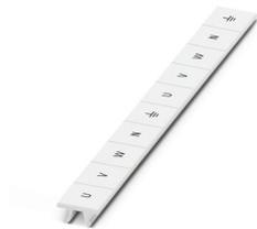
Marker für Klemmen, Streifen, weiß, beschriftet, beschriftbar mit: CMS-P1-PLOTTER, längs: U, V, W, N, GND, U, V, W, N, GND, Montageart: verrasten, für Klemmenbreite: 10,2 mm, Schriftfeldgröße: 10,15 x 10,5 mm, Anzahl der Einzelschilder: 10
