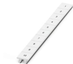
Zackband, Streifen, weiß, beschriftet, beschriftbar mit: CMS-P1-PLOTTER, quer bedruckt: fortlaufende Zahlen 1 ... 10, 11 ... 20 usw. bis 91 ... 100, Montageart: verrasten, für Klemmenbreite: 10,2 mm, Schriftfeldgröße: 10,15 x 10,5 mm, Anzahl der Einzelschilder: 10
