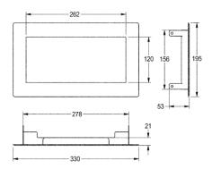
Abfall-Abwurfklappe, für Tischmontage, Chromnickelstahl, sichtbare Oberflächen seidenmatt, Materialstärke 0,8 mm, selbstschliessende Abwurfklappe, ohne Abfallbehälter.
