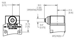
Figure 10. MICRO SWITCH™ BX SERIES SIDE ROLLER PLUNGER, HEAD CODE F • mm [in]
