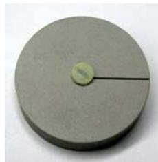
\*\* Metallprüfkörper Ø 25mm; H=6mm mit mittig angeordneter durchgehender Bohrung Ø 4,0mm und Schlitz.
