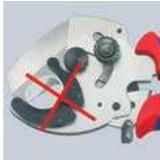
Nicht für dünnwandige Kunststoffrohre geeignet. Dafür bitte Artikel-Nummer 90 20 185 oder 94 10 185 verwenden
