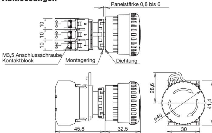
Hinweis: Der Taster wird beim Betätigen verriegelt und entweder durch Drehen oder Ziehen wieder entriegelt.
