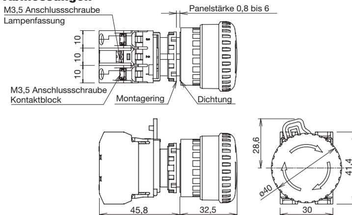
Hinweis: Der Taster wird beim Betätigen verriegelt und entweder durch Drehen oder Ziehen wieder entriegelt.
