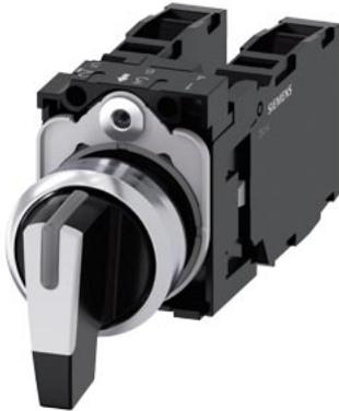
Knebelschalter, 22 mm, rund, Metall, hochglanz, weiß, Knebel, lang, 3 Schaltstellungen I>O<II, tastend, Schaltwinkel 2x45°, 10:30h/12h/13:30h, mit Halter, 1S, 1S, Schraubanschluss
