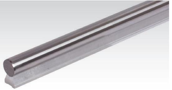
**Werkstoff Welle:** Stahl 1.1213 (Cf53), gehärtet und geschliffen, Härte 62±2 HRC, Durchmesser-Toleranz ISO h6.
