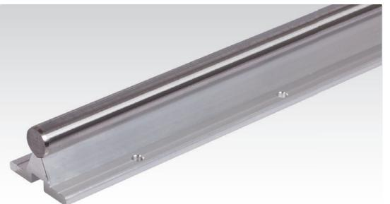
**Werkstoff Welle:** Stahl 1.1213 (Cf53), gehrtet und geschliffen, Hrte 62±2 HRC, Durchmesser-Toleranz ISO h6.
