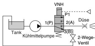
Zur Reduzierung der Pumpenlast wird das Kühlmittel vom Anschluss B zum Tank zurückgeführt.
