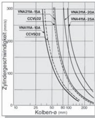
Diese Serie kann die Kapazität herkömmlicher Niederdruck-Hydraulikventile erweitern. Sie ist für den Antrieb von Zylindern mit großem Kolben- $\phi$  sowie für den gleichzeitigen Betrieb mehrerer Zylinder oder dessen Unterbrechung geeignet, und kann wie herkömmliche Niederdruck-Hydraulikeinheiten eingesetzt werden.
