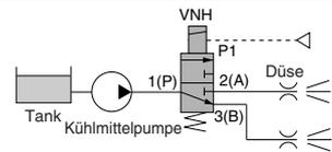
Zum Schalten von Düsen bei Kühlmittelversorgung
